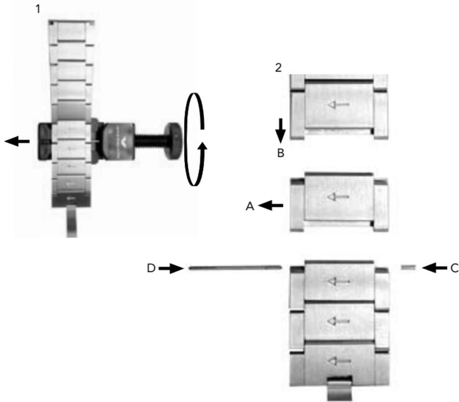
Einstellen der Bandlänge • Sizing of the strap • Ajustement du bracelet • Regolazione della lunghezza del cinturino • Ajuste de la longitud de la correa • Regulação do comprimento da correia • ストラップの調節
