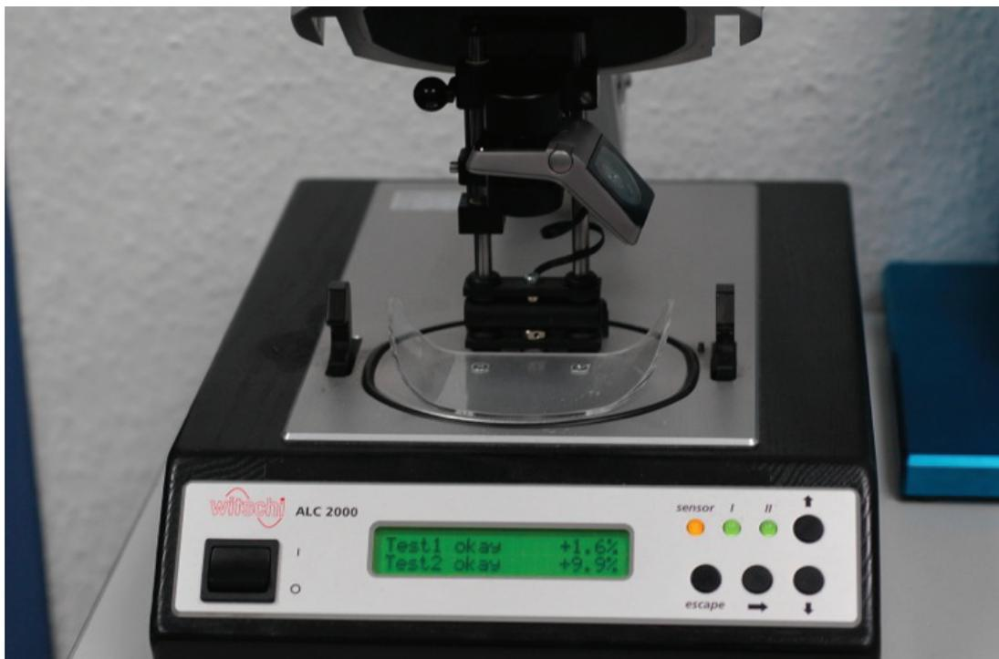
Erfolgreicher Wasserdichtigkeits-Test einer SPARC MGS: Beide Stufen, Test 1 (0.5 bar = 50 cm Tiefe) und Test 2 (10 bar = 100 m Tiefe) werden mit grünen Kontroll-Indikatoren als »OK« bezeichnet.
